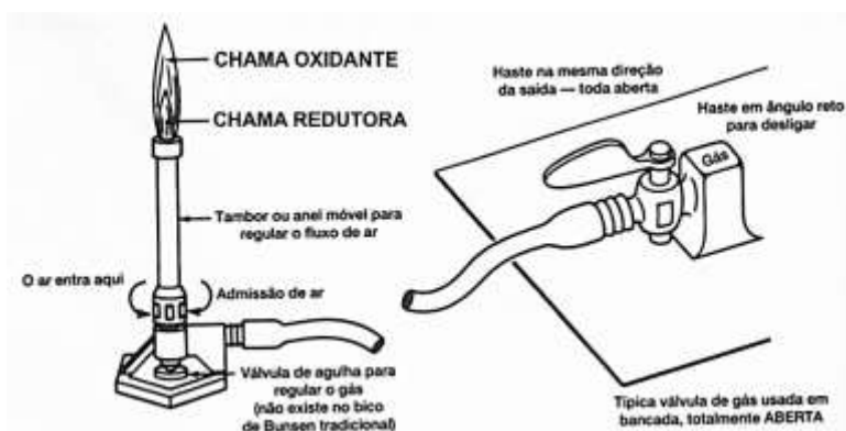
Figura 3: Esquema do funcionamento do Bico de Bunsen.
